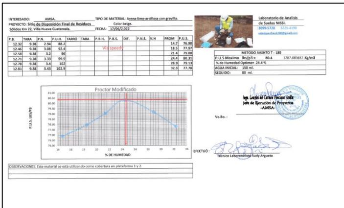
Proctor Modificado del Método AASHTO T-180 dando un resultado de Peso Unitario Seco Máximo de 80.4 lbs/p3 (1,287.88 kg/m<sup>3</sup>).
