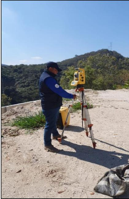
*Imagen 12, levantamiento topográfico en zona de extracción*
